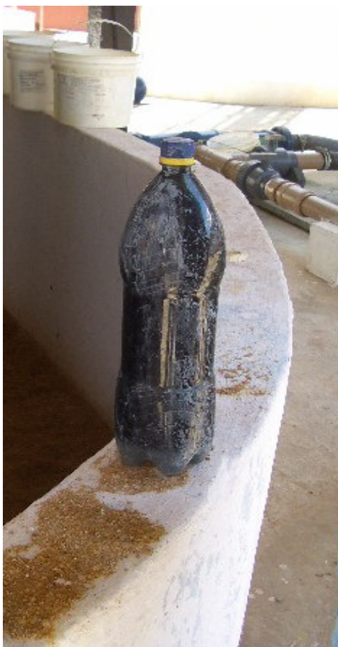
FIGURA 01: Aspecto da amostra do efluente com o cromo solubilizado
