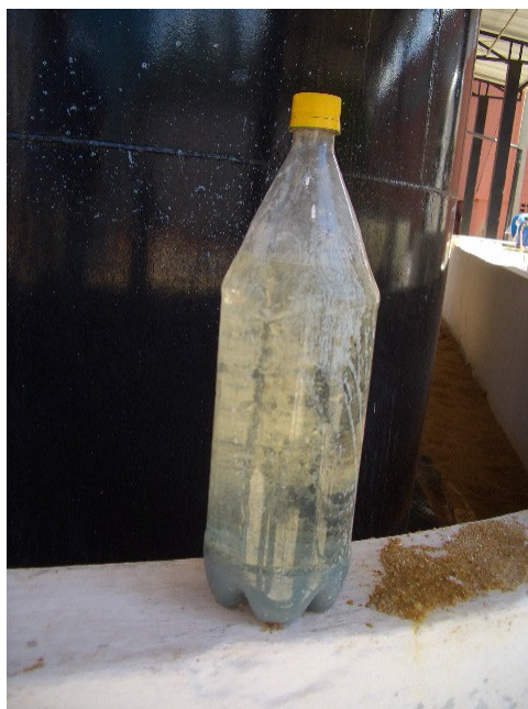
FIGURA 02: Aspecto da amostra do efluente com o cromo precipitado
